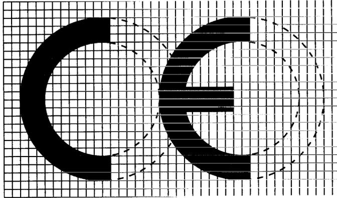
Bei Verkleinerung oder Vergrößerung der CE-Kennzeichnung müssen die sich aus dem oben abgebildeten Raster ergebenden Proportionen eingehalten werden.
